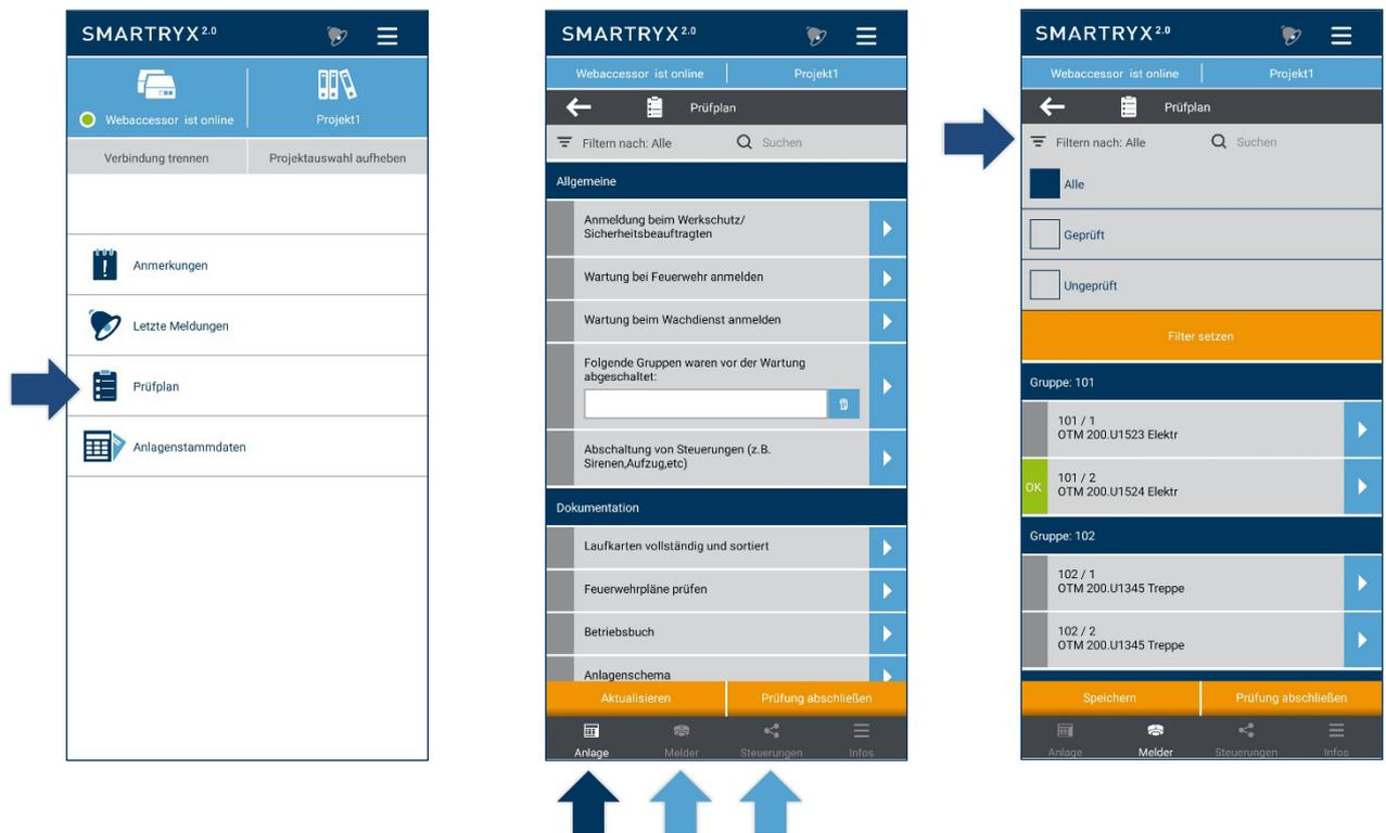
Der Prüfplan gliedert sich in Anlage, Melder und Steuerungen. Die entsprechende Navigation finden Sie unten im Bildschirm. In jedem Abschnitt des Prüfplans haben Sie die Möglichkeit, nach „geprüft“ und „ungeprüft“ zu filtern. Klicken Sie hierfür auf das Filter-Icon oben links im Prüfplan und setzen Sie den entsprechenden Filter.
